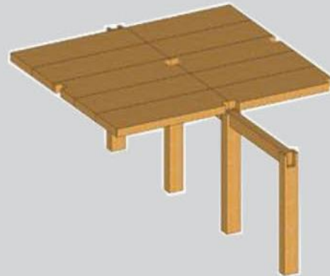
03 | Auflegen vorgefertigter Deckenelemente
