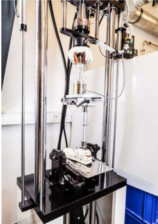
Mechanische Prüfung von Prothesen nach ISO 22675 (links) und 3 D robotergestützte Prüfung, basierend auf realitätsnahen biomechanischen Bewegungsdaten (rechts)
