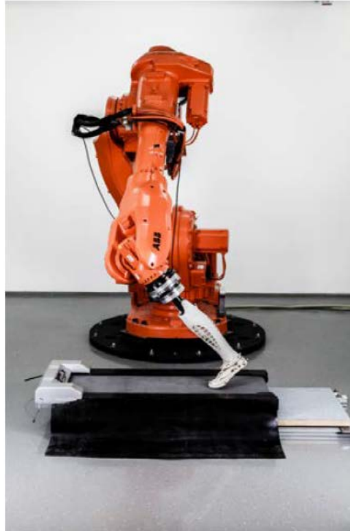
Mechanische Prüfung von Prothesen nach ISO 22675 (links) und 3 D robotergestützte Prüfung, basierend auf realitätsnahen biomechanischen Bewegungsdaten (rechts)
